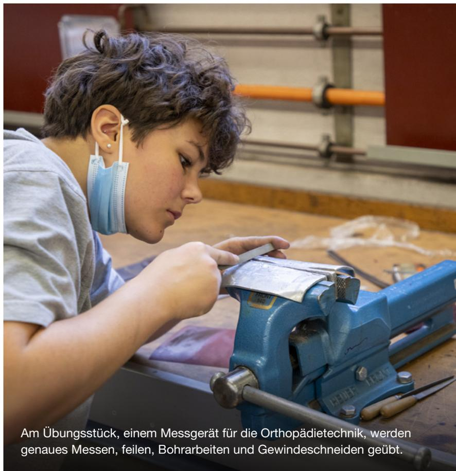
Am Übungsstück, einem Messgerät für die Orthopädiertechnik, werden genaues Messen, feilen, Bohrarbeiten und Gewindeschneiden geübt.
